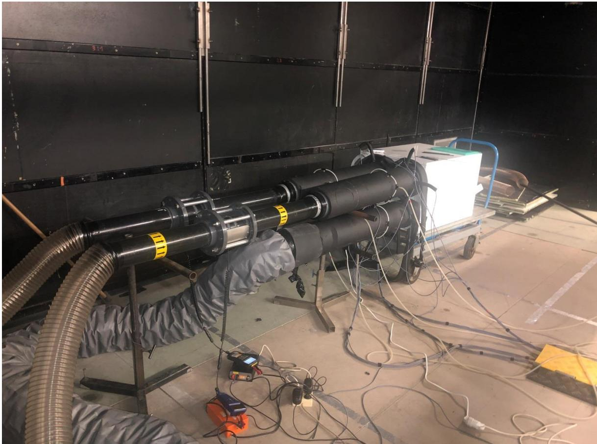
Note : L'appareil a été testé en position horizontale. Les conditions d'essais sont telles qu'aucun phénomène de condensation ne se produit dans l'échangeur : La position n'influence donc pas les performances.
