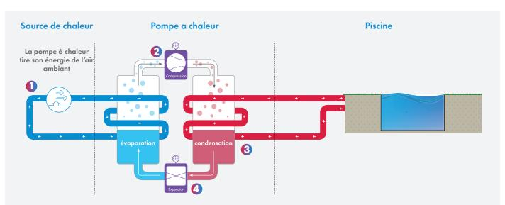
La pompe à chaleur extrait l'énergie d'une source de chaleur (l'air)à l'aide d'un échangeur de chaleur et d'un ventilateur,. Cette énergie sera utilisée pour évaporer le réfrigérant dans le système. Le réfrigérant a comme avantage qu'il atteint son point d'ébullition et s'évapore à basse température. Ces vapeurs sont ensuite transportées vers un compresseur.
