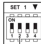
\*Assurez-vous que l'appareil est hors tension ou que les disjoncteur est désactivé lors du changement du commutateur DIP.
