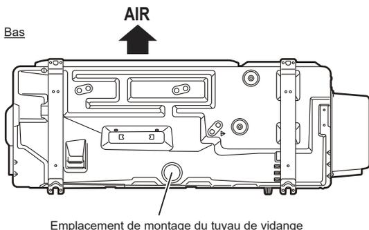
Comme l'eau de vidange s'écoule de l'unité extérieure pendant le chauffage, installez le tuyau de vidange et raccordez-le à un flexible de 16 mm disponible dans le commerce. (Modèle à cycle inversé uniquement)
