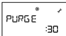
Le cycle de purge active les circulateurs à rythme alterné pour permettre le déplacement des bulles d'air accumulées aux points hauts et leur évacuation par le purgeur automatique du **Pilote**.
