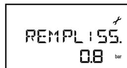
Pendant l'étape de remplissage, le pilote indique la pression mesurée dans le circuit chauffage.
