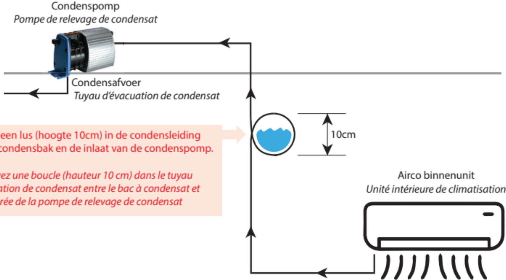
Voorzie een lus (hoogte 10cm) in de condensleiding tussen de condensbak en de inlaat van de condenspomp.
